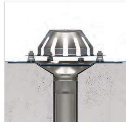
Auf Grund der Vakuumplatte auf dem Ablauf füllt sich das Rohr schnell zu 100%, die Luft wird aus dem System gedrängt und erzeugt eine sogenannte Druckströmung (Vakuum), die das Wasser mit einer größeren Geschwindigkeit abfließen lässt.
